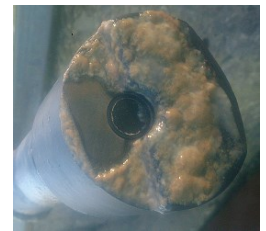
Fig. 1 Encrassement du capteur
