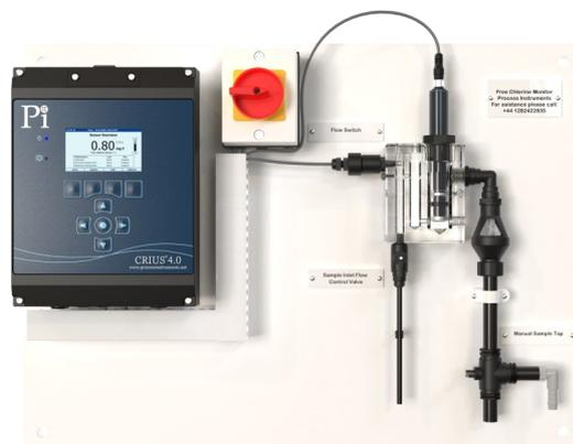
Retirez délicatement l'excès de solution d'électrolyte du capteur et vérifiez s'il y a des bulles à l'extrémité de la membrane. Ne pas frotter ou essuyer la membrane. Faites glisser le joint dans la rainure, en couvrant le trou d'évent. Lavez l'excès d'électrolyte avec de l'eau. La polarisation initiale dure jusqu'à 2 heures avant l'étalonnage. L'étalonnage doit être répété après 24 heures.
