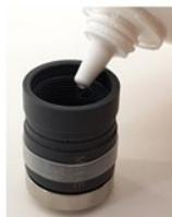
Abaisser verticalement la sonde dans le bouchon-membrane rempli. Ne couvrez pas le trou d'évent. Vissez le bouchon-membrane sur le capteur jusqu'à ce qu'il n'y ait plus d'espace. L'excès d'électrolyte s'échappera par le trou d'évent du bouchon-membrane. Ne couvrez pas ce trou d'évent avec votre doigt, cela créerait une surpression qui endommagera la membrane.
