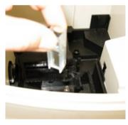
Cette méthode est basée sur la transmission de la lumière. Une longueur d'onde spécifique de la lumière (environ 360 nm dans le cas du dioxyde de chlore) est passée à travers une cuvette contenant l'échantillon, et la transmission/ absorption est mesurée.
