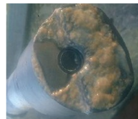
Fig. 1 : Encrassement du capteur
